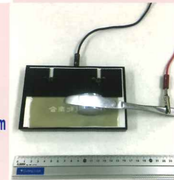
⑭ ベンチマーカー カーボン面サイズ 縦102mm ×横152mm
