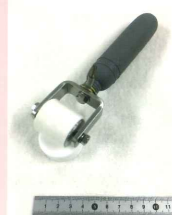
⑬ ローラーマーカー ヘッドサイズ 直径25mm×幅30mm
